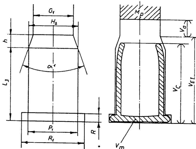
*Vei.* Volume della camera minima secondo la tab. VI-B (IDCC della C.I.P.) degli apparecchi per la misurazione (canna - campione)
