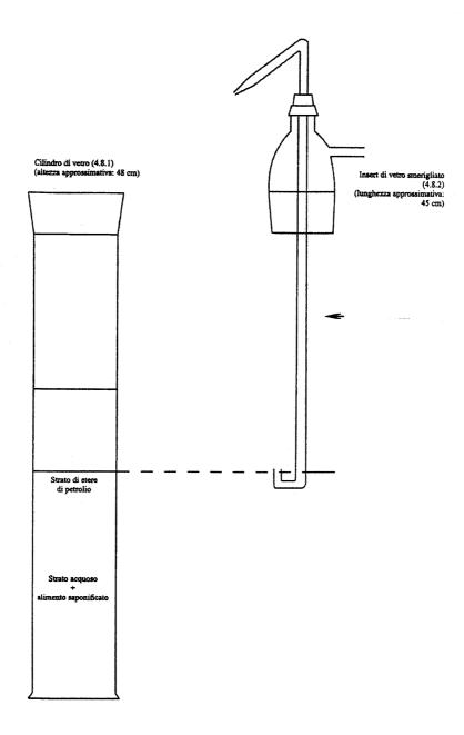
Figura 1: Apparecchiatura per estrazione (4.8)
