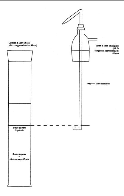
Figura 1: Apparecchiatura per estrazione (4.8)
