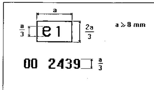
Il marchio di omologazione di componente qui raffigurato indica che il dispositivo di riscaldamento a combustione è stato omologato in Germania (e 1) con il numero di omologazione 2439. Le prime due cifre (00) indicano che il componente è stato omologato in conformità della presente direttiva.
