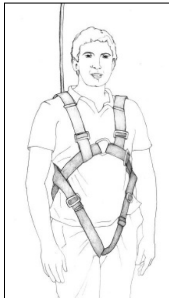
figura 6: Imbragatura di sicurezza con collegamento al dispositivo anticaduta
