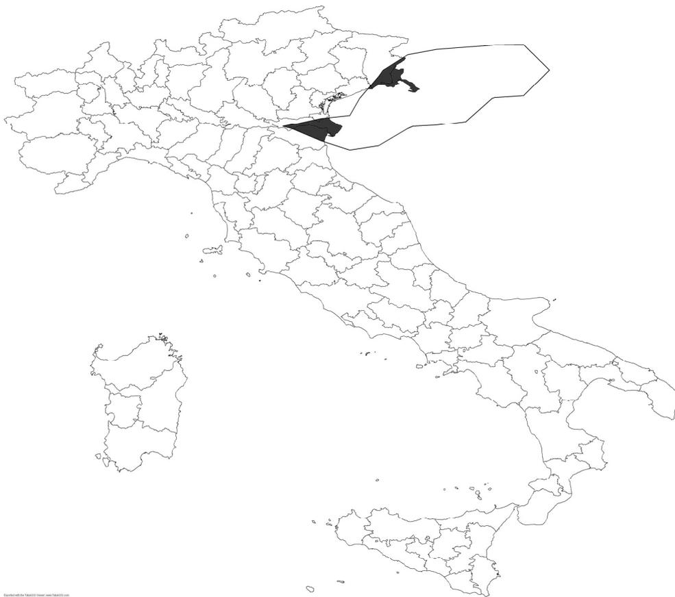
Fig. A4.5 Curva di isodose (10 mSv alla tiroide nei bambini - 48 h) Incidente Centrale di Krško
