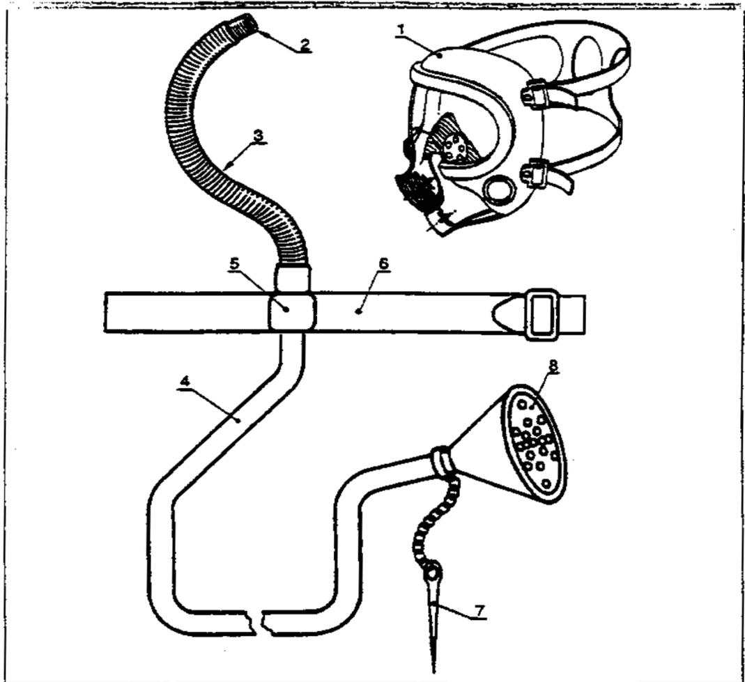
Questo respiratore consente all'utilizzatore di essere rifornito di aria non inquinata, mediante la propria azione respiratoria, attraverso un tubo per la presa d'aria esterna. L'aria espirata defluisce nell'atmosfera ambiente.
