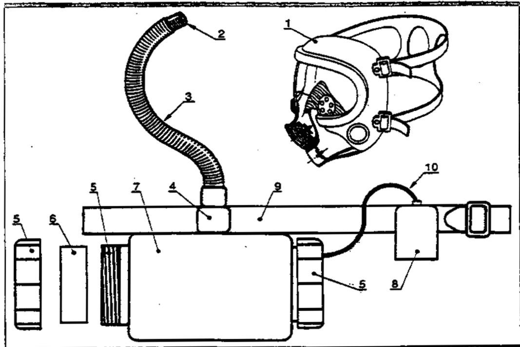
Questi apparecchi sono costituiti da un facciale (maschera intera o semimaschera o quarto di maschera), da un elettroventilatore che fornisce all'interno del facciale aria filtrata e da uno o più filtri antipolvere attraverso i quali passa tutta l'aria fornita al facciale. L'alimentatore di energia per il ventilatore è generalmente trasportato dallo stesso utilizzatore. L'aria espirata e quella in eccesso passa direttamente nell'atmosfera ambiente tramite le valvole di espirazione.
