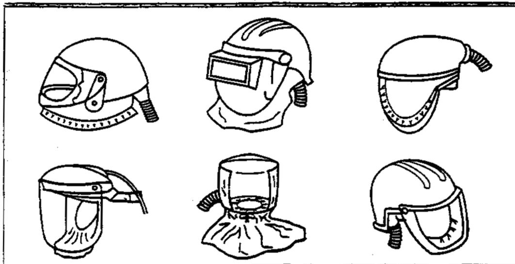
La classificazione dell'apparecchio coincide con quella della marcatura sul filtro e si deve tenere in considerazione che la classificazione THP 3 comporta che il mezzo di protezione sia equipaggiato con un indicatore di flusso o di pressione.
