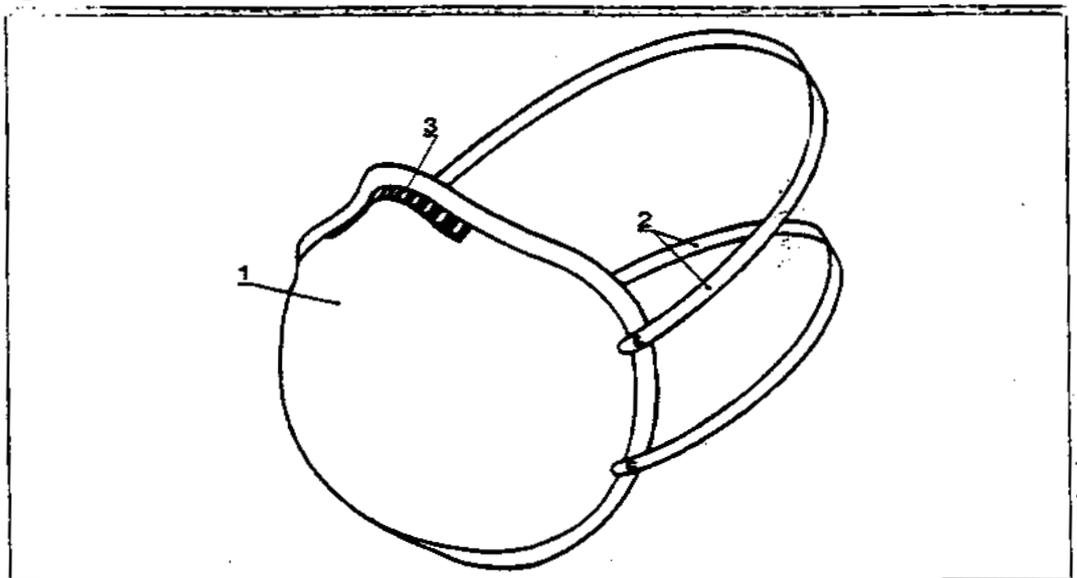
Questo tipo di respiratore a filtro è costituito interamente o prevalentemente di materiale filtrante attraverso il quale passa l'aria inspirata; il respiratore copre almeno il naso e la bocca.
