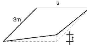
Figura 5.2.14 - Sghembo ammissibile
