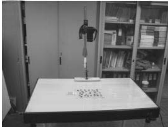
Figura 30. Fotocamera su stativo luminoso per la rilevazione fotografica.
