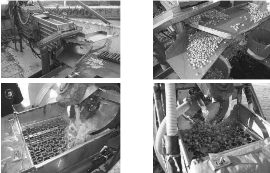
Figura 15. Particolari di un vibrovaglio utilizzato a bordo delle vongolare per la selezione delle taglie commerciali ( \geq 22 mm) di vongole.
