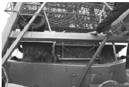
Figura 14. Particolare della draga costituita da una gabbia completamente metallica (a sinistra). Tutte le vongolare hanno la draga sempre posta sulla prua della barca, al termine del traino la draga viene issata a prora tramite il cavo di recupero ed il materiale raccolto viene convogliato in un vascone (a destra) e poi ad un vaglio per la selezione delle taglie commerciabili.
