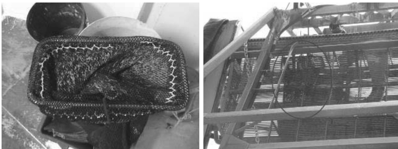
Figura 29. Retino campionatore costituito da un frame di acciaio inox (40 cm di lunghezza interna, 20 cm di larghezza interna con uno spessore di 1 cm) e una rete di nylon con maglia da 12 mm di apertura.
