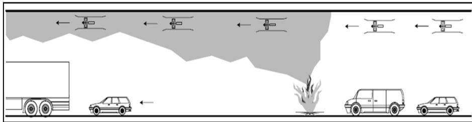
Ventilazione naturale: flusso di aria che si instaura all'interno della galleria dovuto alla differenza di pressione tra i portali, alla pendenza del tunnel e alla differenza di temperatura tra la superficie delle strutture della galleria e l'aria ambiente.
