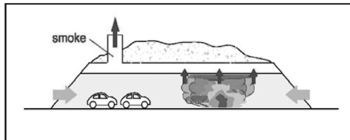
Ventilazione trasversale: sistema di ventilazione nel quale generalmente l'aria fresca è convogliata in un condotto di ventilazione parallelo all'asse della galleria e l'aria viziata è estratta da un altro condotto. L'aria fresca immessa e l'aria viziata estratta «depurano» trasversalmente la galleria.
