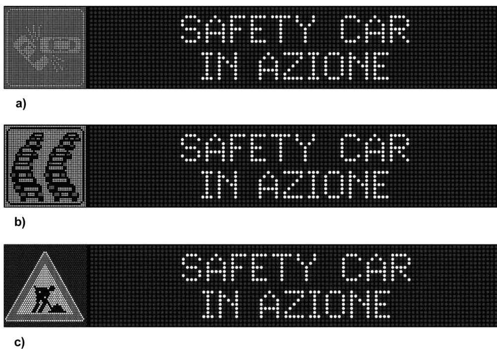
Fig. 4: Indicazione del presegnalamento del dispositivo safety car su pannello a messaggio variabile a due righe di testo, riportante esempi di indicazione della potenziale situazione di pericolo presente sul tratto stradale.
