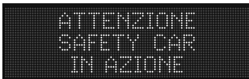
Fig. 2: Indicazione del presegnalamento del dispositivo safety car su pannello a messaggio variabile a due righe di testo senza l'utilizzo di pittogrammi.
