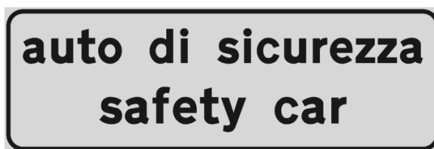
Fig. 1: Pannello segnaletico rettangolare di tipo fisso ad angoli arrotondati, realizzato con pellicola retroriflettente a elevata efficienza, di dimensioni non inferiori a 1,20 x 0,40 m, da utilizzare sui veicoli impiegati nell'esecuzione del dispositivo safety car .
